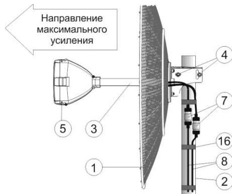
Рисунок 2 - Установка антенны на мачту
