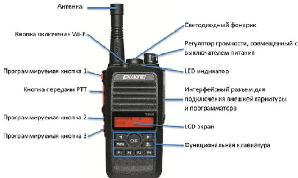
**Антенна** - служит для приема и передачи радиосигнала.
