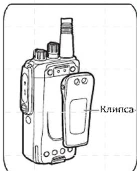
В случае необходимости, установите клипсу для ремня на задней части радиостанции при помощи двух винтов, входящих в комплект поставки.
