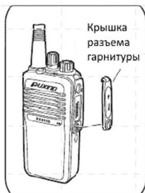
Если Вы не используете дополнительную гарнитуру, рекомендуется установить крышку разъема гарнитуры для обеспечения большей влагонепроницаемости.
