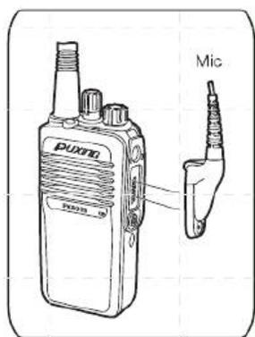
В случае необходимости использования внешней гарнитуры, снимите крышку гарнитуры на корпусе радиостанции и подключите к интерфейсу внешнюю гарнитуру.
